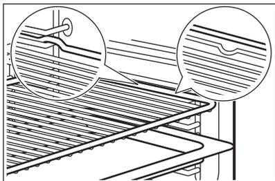
Se la teglia è inclinata, posizionarla verso la parte posteriore dell'interno del forno.
